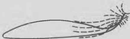
Рис.1. Схема обтекания активно плывущего дельфина
