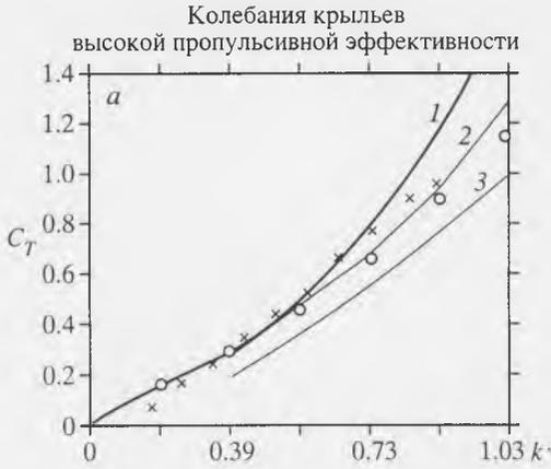
**Рис. 17.** Коэффициент тяги  $C_T$  в зависимости от параметра  $k = \omega c / 2U$ , где  $\omega = 2\pi f$  – частота колебаний крыла,  $c$  – хорда,  $U$  – скорость набегающего потока
