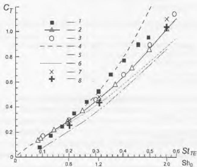
Рис. 2. Сравнение результатов экспериментального определения коэффициента тяги прямоугольного жесткого крыла с удлинением больше 6 (1) [20], нелинейного численного решения (2), (3), (5), (6) [18, 20, 21], линейной теории (4) [5] и вычислений по полученным формулам (7), (8) [18]. Вычисления проведены без учета сопротивления трения и формы (7) и с учетом сопротивления крыла (8). Кинематические параметры крыла:  $y_0/b = 0.75$ ,  $\alpha_0 = 15^\circ$ .
