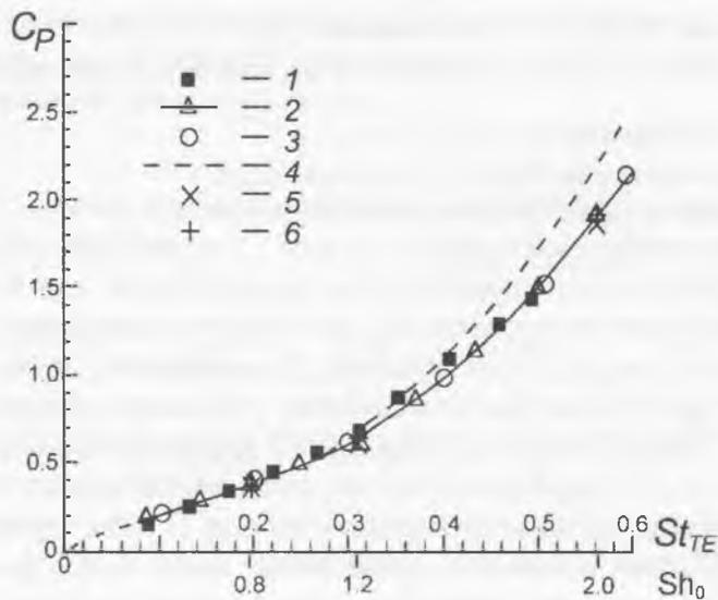
Рис. 3. Сравнение результатов экспериментального определения коэффициента мощности (1) [20], нелинейного численного решения (2), (3) [19, 20], линейной теории (4) [5] и вычислений по полученным формулам (5), (6) [18] без учета сопротивления трения и формы крыла и с учетом соответственно. Кинематические параметры крыла:  $y_0/b = 0.75$ ,  $\alpha_0 = 15^\circ$ .
