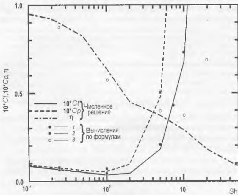
Рис. 5. Зависимость коэффициентов тяги, мощности и полезного действия от числа Струхала для комбинации линейных и угловых колебаний,  $Sh_0 y_0/b = 0.1$  [22]. Численное решение по данным работы [22]; 1, 2, 3 – значения, вычисленные по формулам работы [18].
