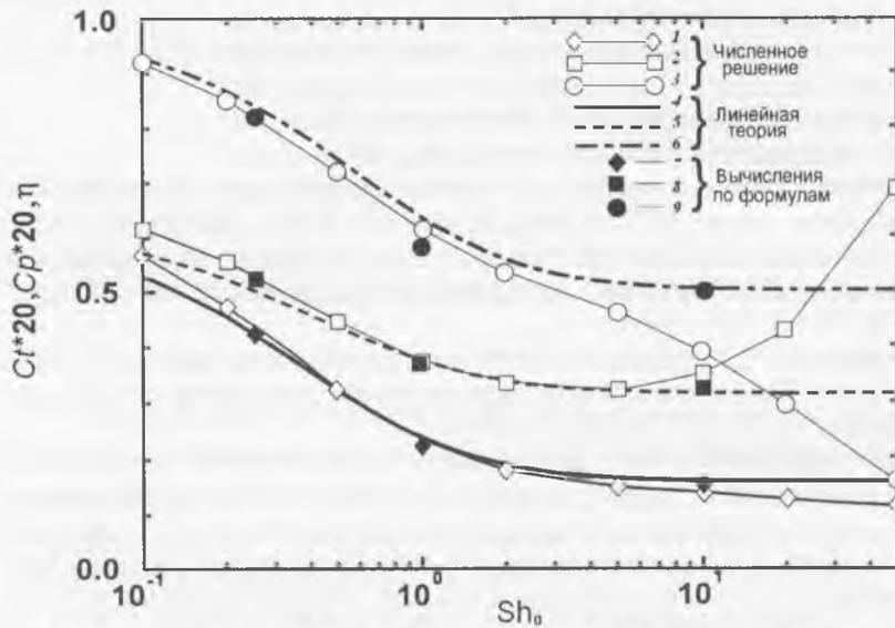
Рис. 4. Зависимость коэффициентов тяги (поз. 1, 4, 7), мощности (поз. 2, 5, 8) и полезного действия (поз. 3, 6, 9) от числа Струхала для чисто линейных колебаний.  $Sh_0 y_0/b = 0.1$  [22]. 1, 2, 3 – данные работы [22]; 4, 5, 6 – данные работы [5]; 7, 8, 9 – значения, вычисленные по формулам работы [18].
