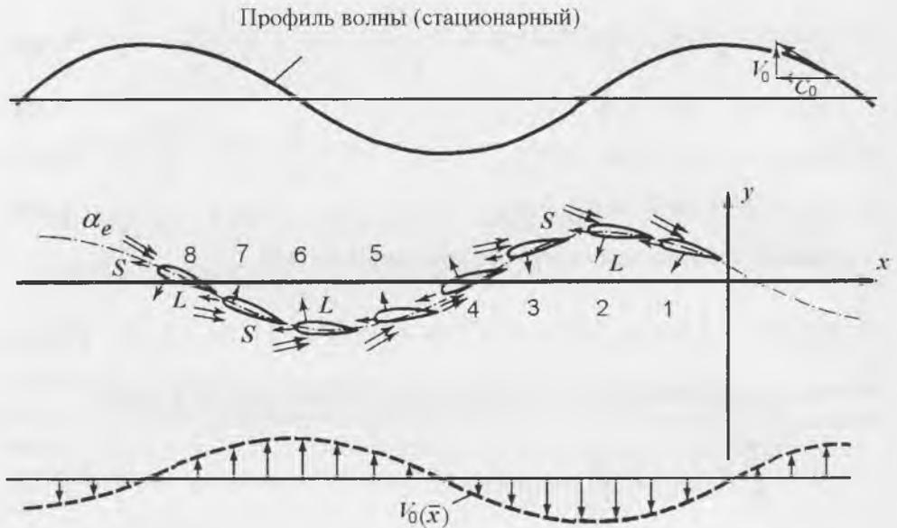
Рис. 1.16. Схема, поясняющая механизм заимствования энергии потока для движения животного. Пояснения в тексте (по: Wu, CHWANG, 1975).
