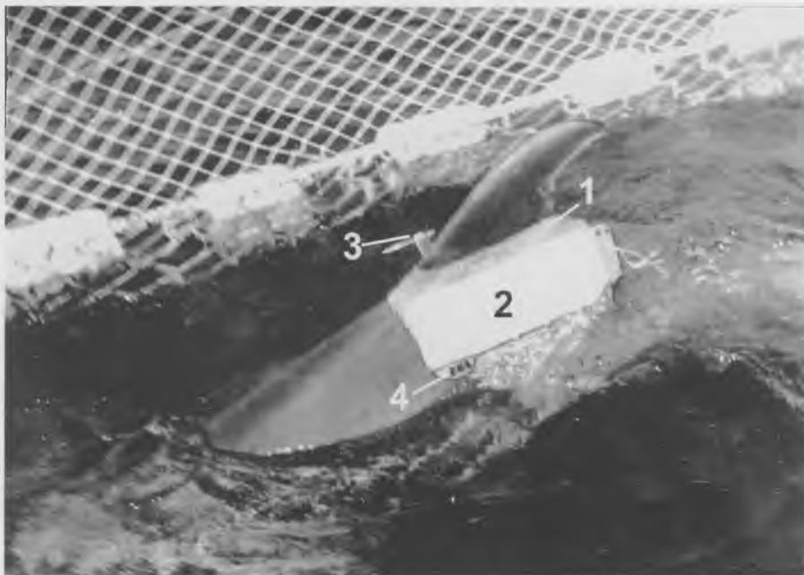
Рис. 5.57. Дельфин с закрепленным на нем поясом и аппаратурой. 1 — пояс, 2 — аппаратура, 3 — приемник пульсаций давления, 4 — измеритель скорости (вертушка).
