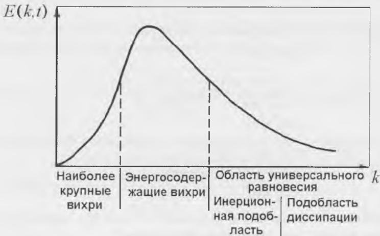
Рис. 4.18. РАСПРЕДЕЛЕНИЕ ПЛОТНОСТИ ЭНЕРГИИ ВИХРЕЙ В ЗАВИСИМОСТИ ОТ ИХ ВОЛНОВЫХ ЧИСЕЛ (по: ХИНЦЕ, 1963).
