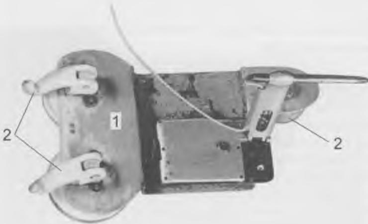
Рис. 5.63. Платформа (1) на присосках (2) для крепления приемника пульсаций.
