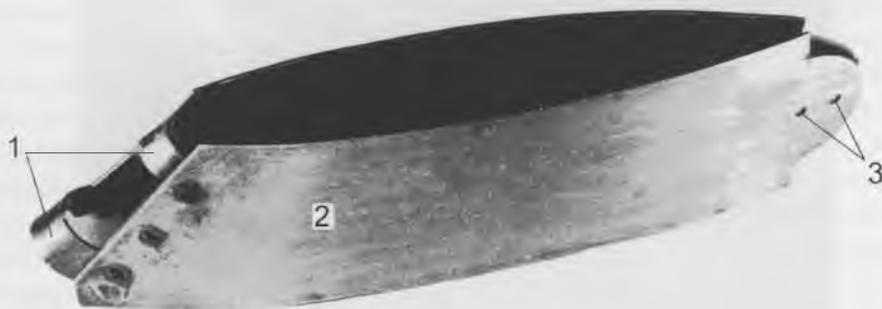
Рис. 5.58. Зажим для крепления аппаратуры на спинном плавнике дельфина. Обозначения в тексте.
