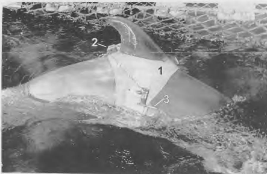
Рис. 5.56. Дельфин с закрепленным на нем поясом и аппаратурой. 1 — пояс, 2 — аппаратура, 3 — приемник пульсаций давления.
