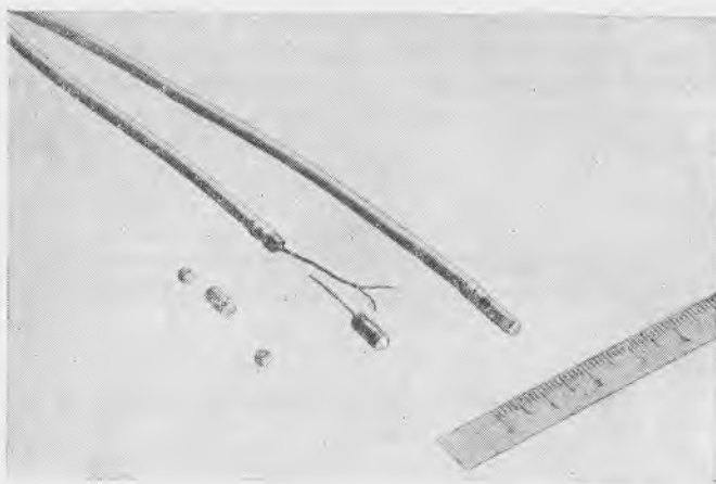
Рис. 12. Элементы цилиндрического приемника ультразвука в процессе сборки
