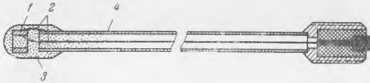
Рис. 10. Схема простейшего цилиндрического приемника ультразвука
