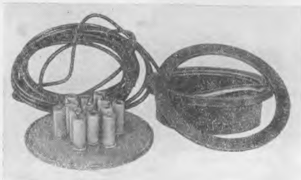
Рис. 28. Конструкция резонансного приемника ультразвука с «мозаикой»
