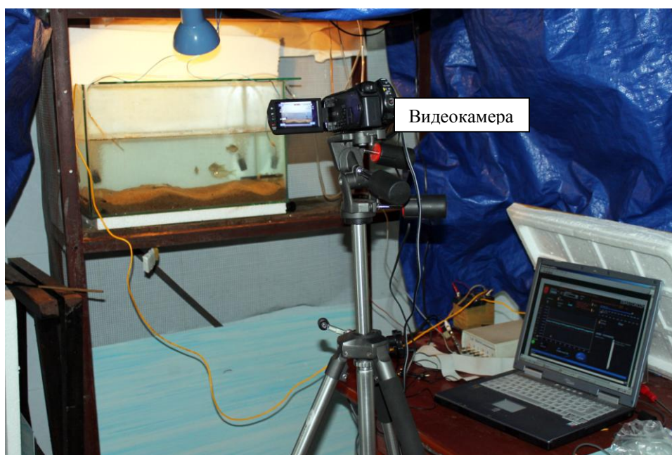
Рис. 2. Синхронная видеорегистрация поведения звездочетов и регистрация электрических разрядов на компьютер
