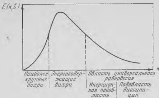
Рис. 18. Распределение плотности энергии вихрей в зависимости от их волновых чисел (по Хинце, 1963)
