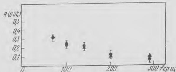
Рис. 104. Поперечная пространственная корреляция пульсаций давления в пограничном слое дельфина при движении дельфина по инерции с турбулизатором и без него в зависимости от частоты
