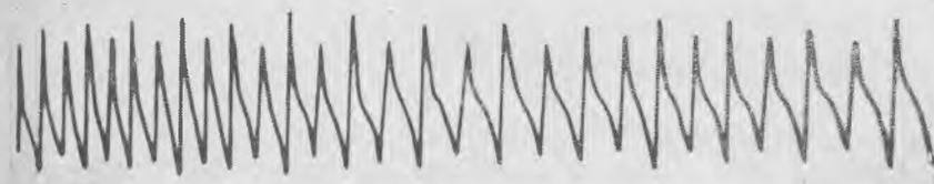
Рис. 68. Осциллограмма импульсов, несущая информацию о скорости потока
