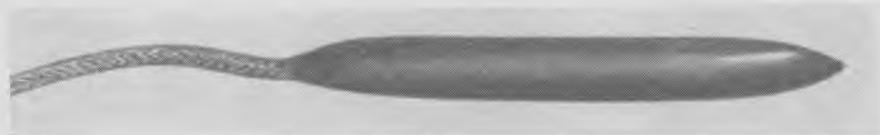
Рис. 49. Приемник с чувствительным элементом в виде тонкой пластинки
