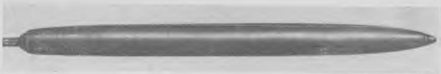
Рис. 48. Приемник с чувствительным элементом круглого сечения
