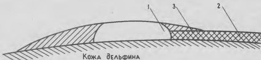
Рис.1. Приемник пульсаций давления с обтекателем:
