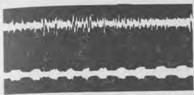
Рис. 3.12. Осциллограмма пульсаций давления на участке времени от 0,6 до 0,85 с (см. рис. 3.11)
