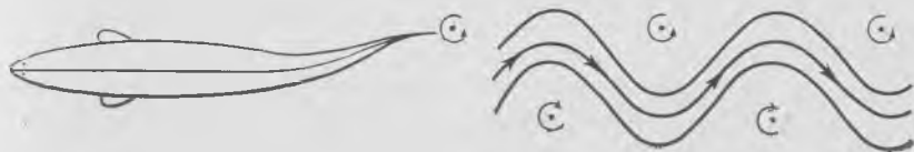
Рис. 1.22. Схема, поясняющая физический механизм работы полулунного плавника (по: Лайтхилл [23])
